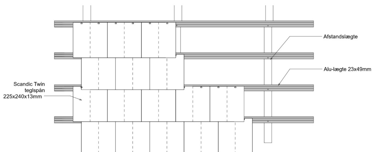
Figur 10 Opstalt af montage af teglene.
