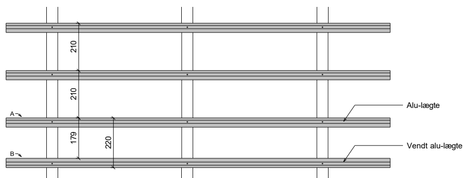
Figur 8 Udsnit af opstalt af de nederste alu-lægter.
